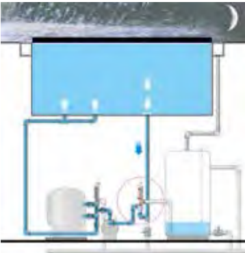
Spaarstand, afzuiging via bodemput i.p.v overloopgoot (buffer), indien afdekking gesloten is.
